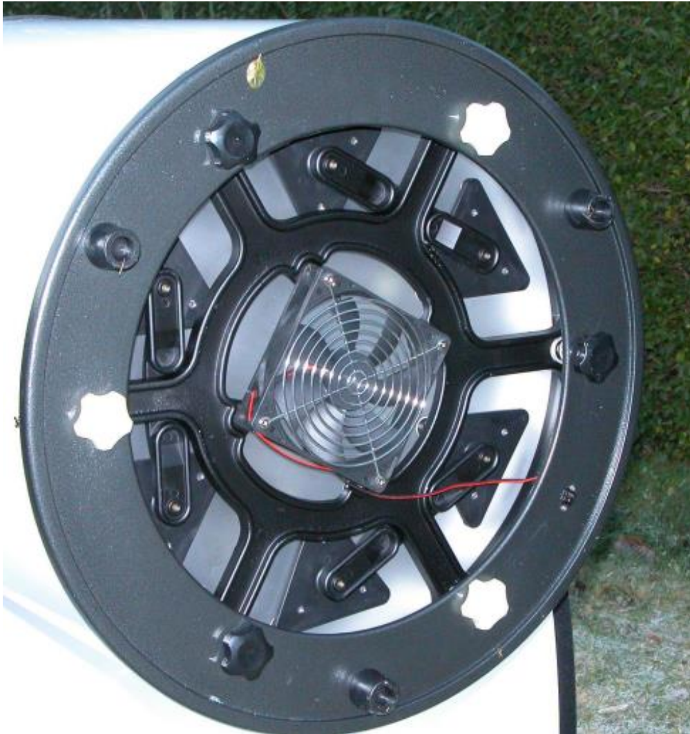
Foto 5: Collimatiebouten van de hoofdspiegel
